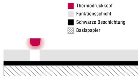
Die Schrift entsteht durch eine physikalische Reaktion: Durch die Hitze des Druckkopfs wird die obere, leicht opake Schicht des PURE Papiers durchsichtig, die darunter liegende schwarze Schicht wird sichtbar. Da die obere Schicht leicht opak ist, erscheint das Papier hellgrau, lässt sich also leicht von Standard-Thermopapieren unterscheiden.
